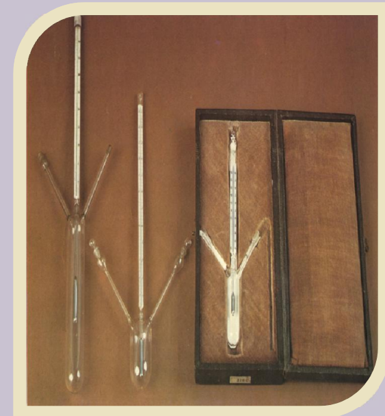
Менделеев сконструировал пикнометр - прибор для определения плотности жидкости
